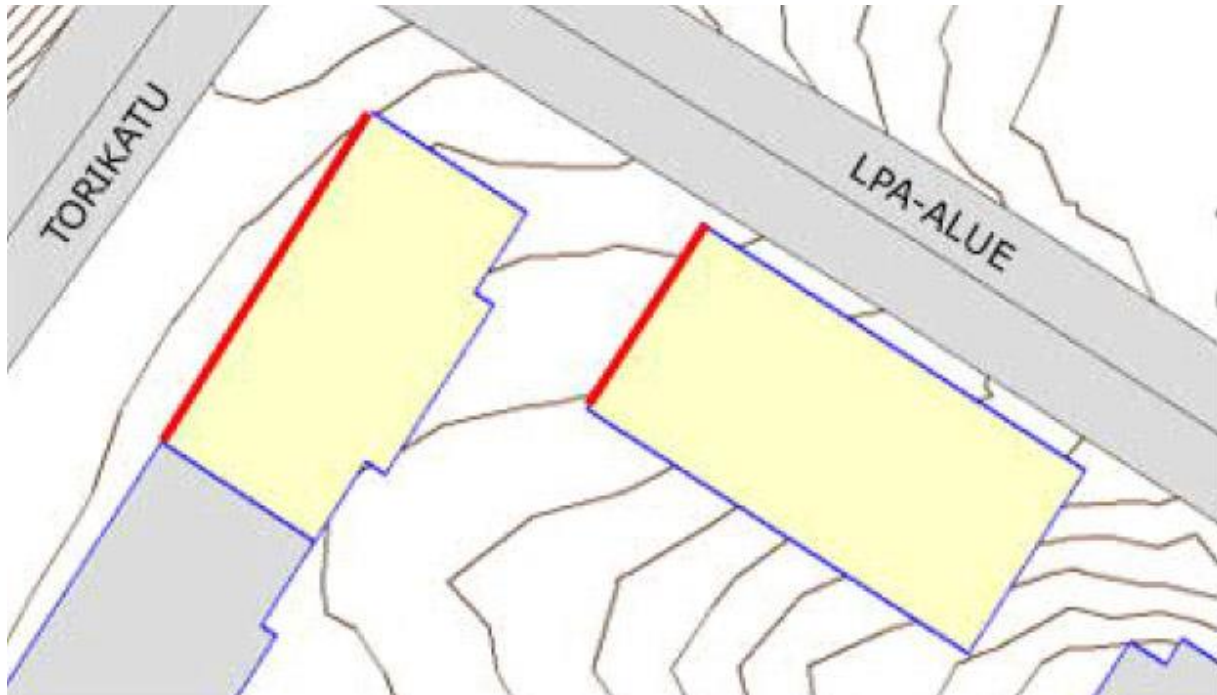
Kuva 8. Ympäristömeluselvitys. Melun asettamat vaatimukset parvekelasituksen laajuudelle. Parvekelasitettavat alueet on merkitty punaisella. Kuva: Sitowise Oy.
