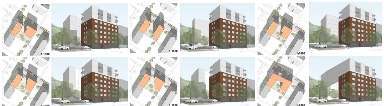
Kuva 15. Viitesuunnitelmat, alustavia kahdeksan- ja yhdeksänkerroksisia uuden kerrostalon massoitteluvaihtoehtoja 2019. Kuvissa näkyy Torikatu 49:n korottaminen kahdella kerroksella. Kuvat: Arkkitehtitoimisto Kanttia2 Oy.
