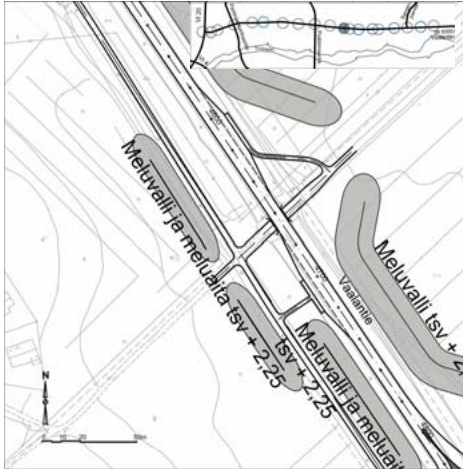
Kuva 30. Uusi kevyen liikenteen alikulku Hiukkavaaran keskustan ja Kivikkokankaan välisellä tieosuudella
