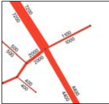
Kuva 22. Ennusteliikennemäärät Yrjö Saarelan tien liittymässä
