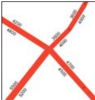
Kuva 15. Ennusteliikennemäärät Parkkisenkankaantien liittymässä
