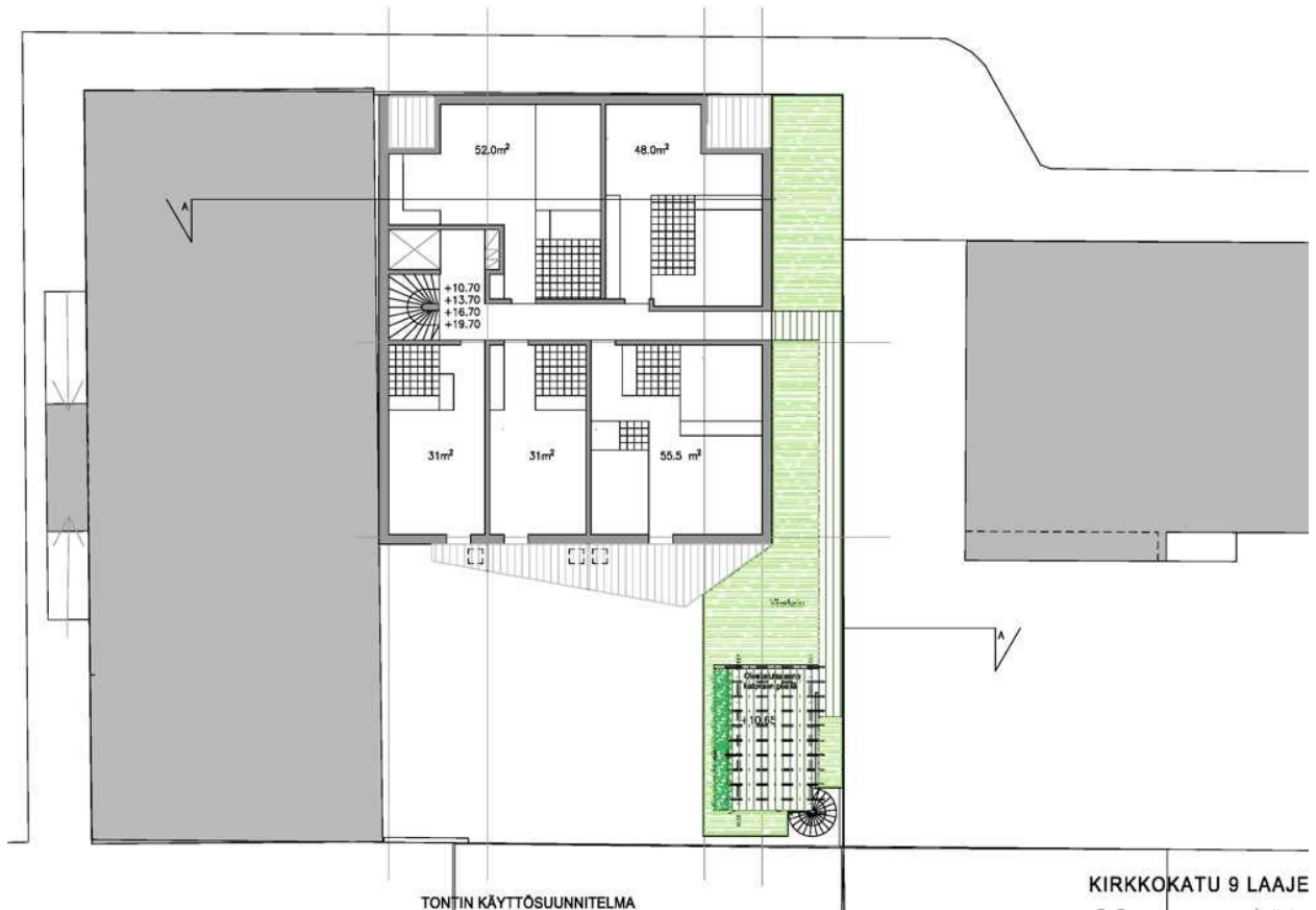
Kuvat: Viitesuunnitelman maantasokerros ja 2. kerros oleskelupihoineen. (Kiinteistö Osakeyhtiö Oulun Vaikutustalo, Arkkitehtitoimisto Laatio Oy 2021. Ei mittakaavassa.)
