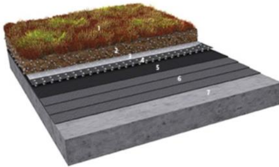
Kuva 6 Viherkaton rakenteet. Kuva: Leca Finland Oy.
