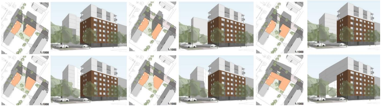
Kuva 15. Viitesuunnitelmat, alustavia kahdeksan- ja yhdeksänkerroksisia uuden kerrostalon mäsöittöluvaihtöehtöjä 2019. Kuvissa näkyy Torikatu 49:n korottaminen kahdella kerroksella. Kuvat: Arkkitehtitöimistö Kanttia2 Oy.
