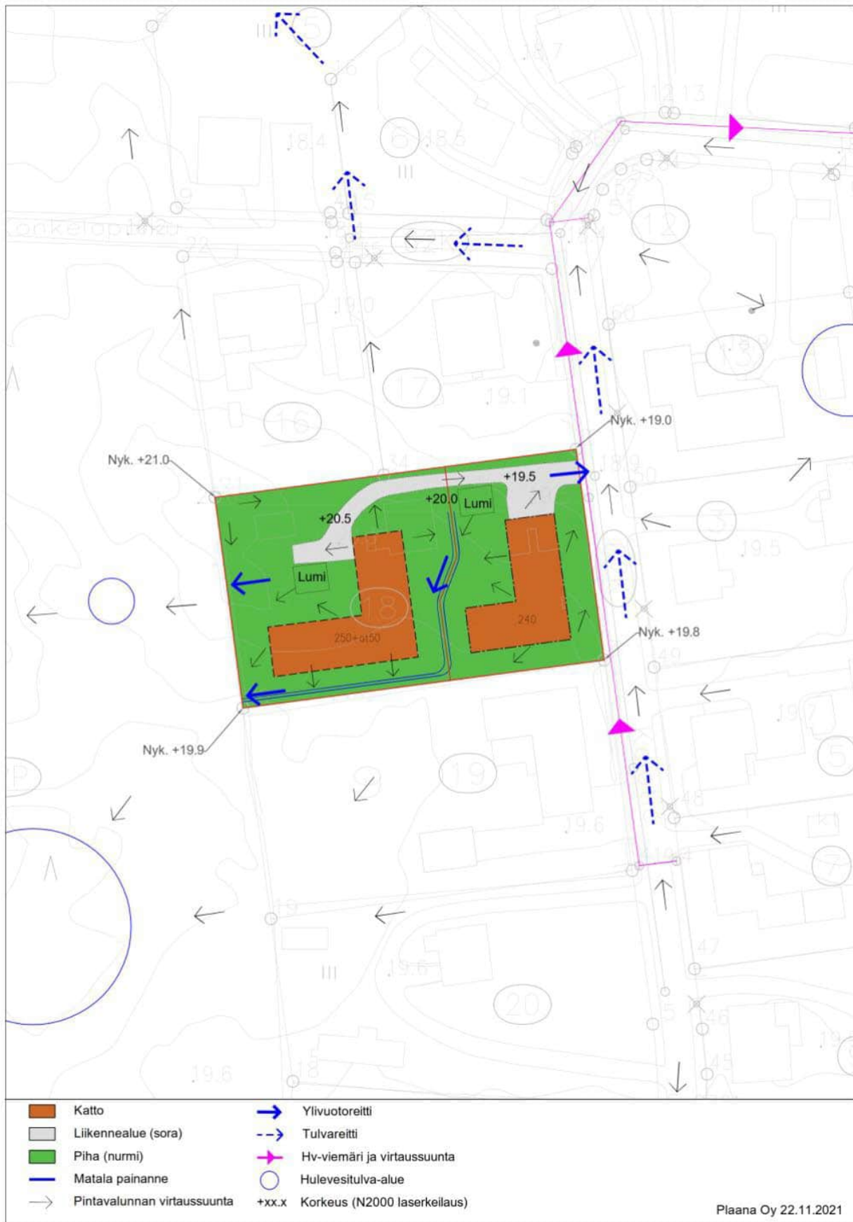
Ote hulevesisuunnitelmasta, 10.12.2021, Plaana Oy
