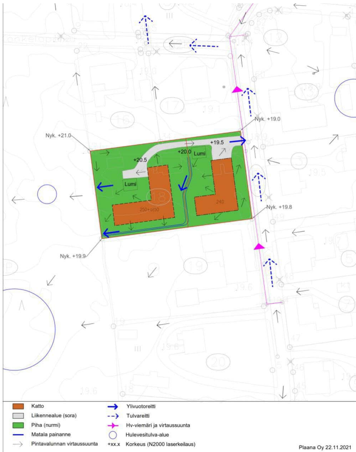
Kuva 3: Ote hulevesiselvityksestä, 10.12.2021, Plaana Oy
