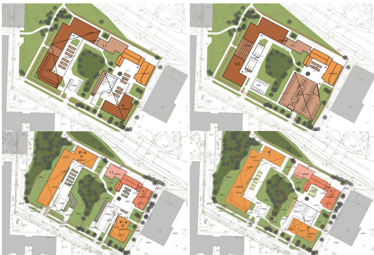
Kuvat: Korttelin 1 maankäytön vaihtoehtoja vuonna 2020–2022. (Oulun kaupunki. Ei mittakaavassa.) Alhaalla oikealla oleva vaihtoehto toimii kaavaehdotuksen viitesuunnitelmana.
