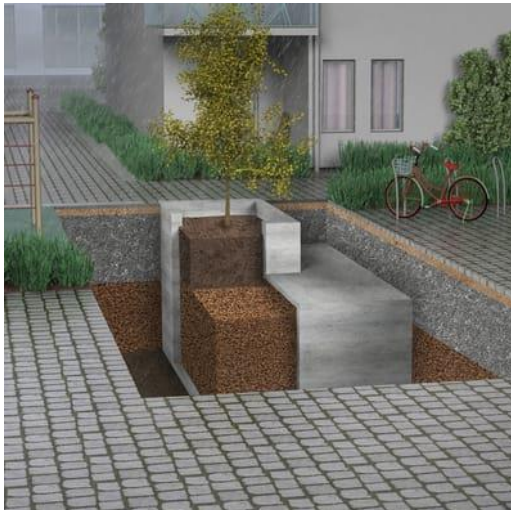
Kuva 9 Leca-sora täytöllä toteutettu biosuodatus ja viivytys rakenne istutuslaatikossa ( www.leca.fi )
