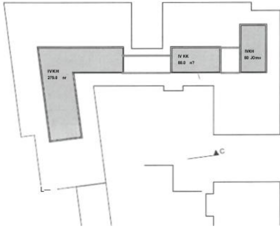
Kuva: Muistutuksen (mustavalkoinen) liite. "Sinisellä kuvattu ilmanvaihtokonehuoneiden sitominen toisiinsa kattomaailman visuaaliseksi rauhoittamiseksi."
