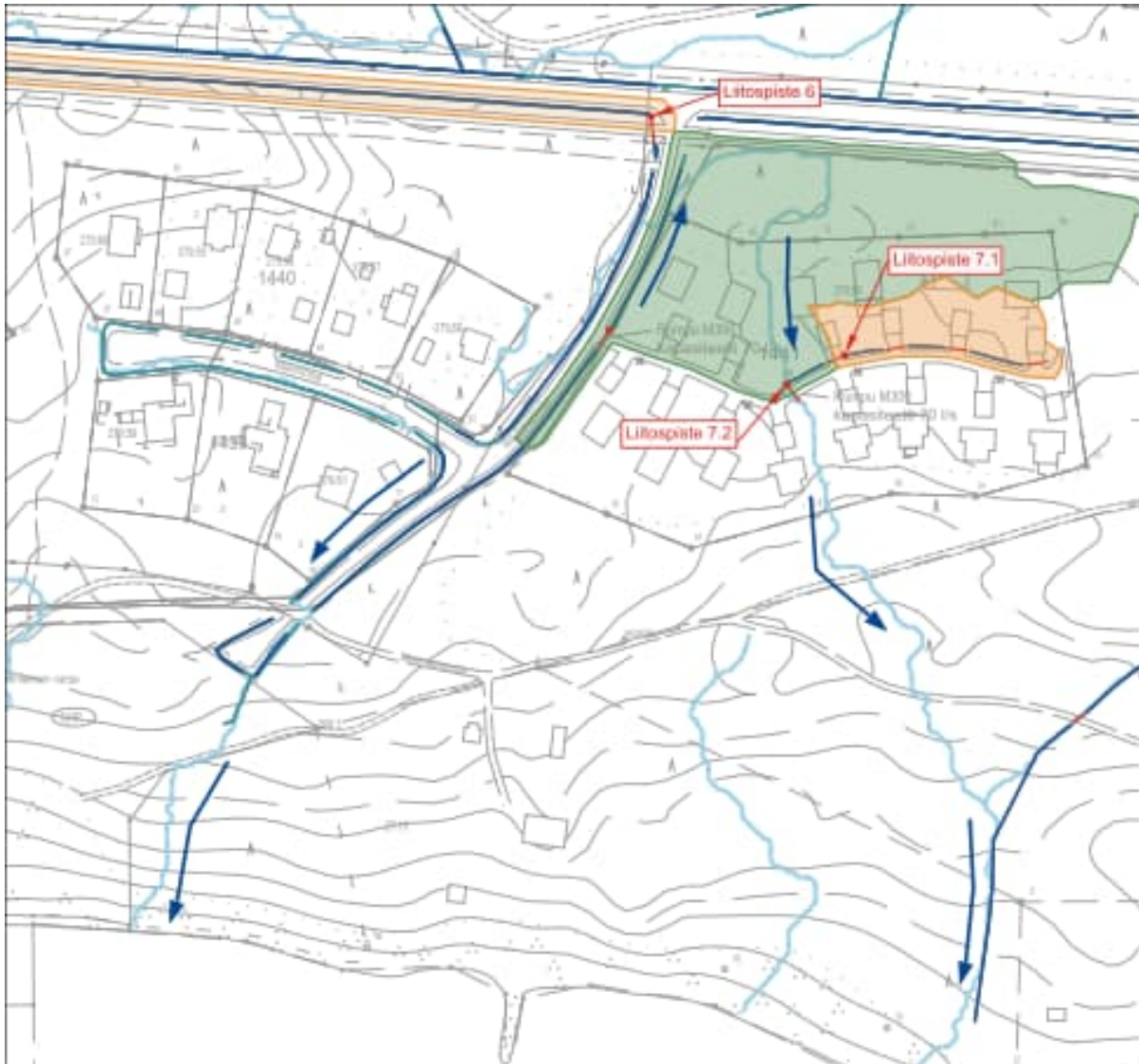
Kuva 19 Weckmanintien rumpujen kapasiteetin laskennassa käytetyt liitospisteet ja osavaluma-alueet.
