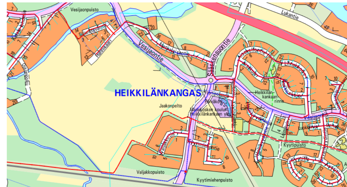
Kuva 4 Opaskartta. Vesijohtoverkko on merkitty karttaan sinisillä viivoilla ja viemäriverkko punaisilla viivoilla. ©Oulun kaupunki, 2021
