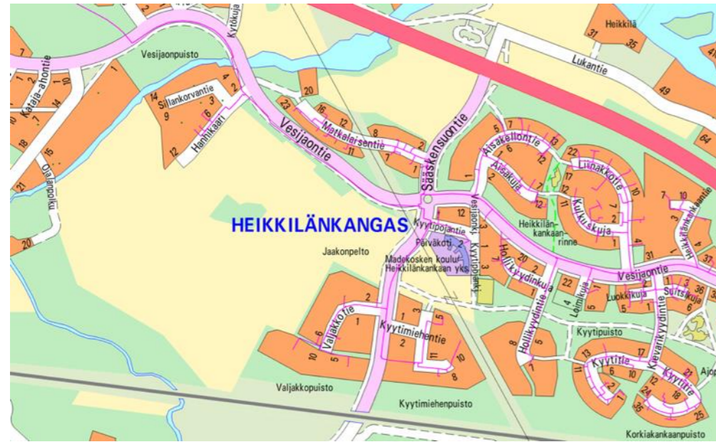
Kuva 6 Opaskartta. Kaukolämpöverkko on merkitty karttaan pinkeillä viivoilla ja maalämpökaivot vihreillä ympyröillä. ©Oulun kaupunki, 2021
