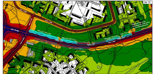
Kuvat 29-30. Päiväaikainen keskiäänitaso LAEQ(07-22), Ennusteliikenne (2030), Suunnitellut melusuojauskset (ml. nykyiset ja Lintulan etl:n meluesteet).
