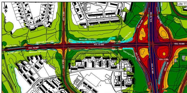
Kuvat 31-32. Yöaikainen keskiäänitaso LAEQ(22-07), Ennusteliikenne (2030), Suunnitellut melusuojauskset (ml. nykyiset ja Lintulan etl:n meluesteet).
