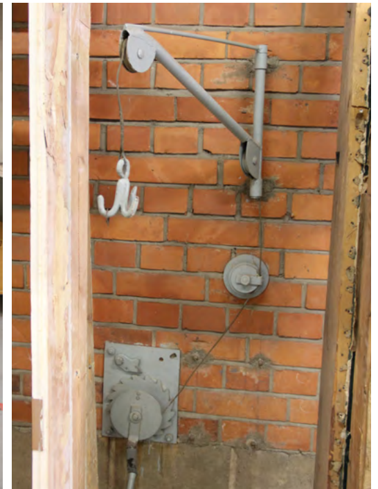
132. Alkuperäinen käsikäyttöinen vinssi.
